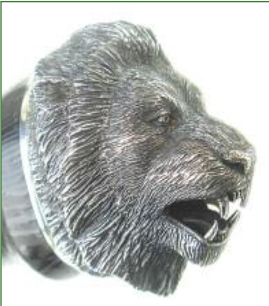
Элементы ножа «Лев», выполненные с помощью точного литья
