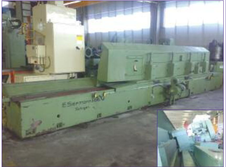
Промышленный гриндер SIEMANN 4000 1970-х годов изготовления
