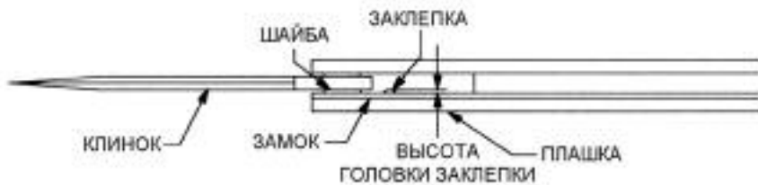
Схема 1. Высота выступающей части заклепки не должна превышать толщину расположенной рядом шайбы. В противном случае заклепка не позволит выдвигать клинок
