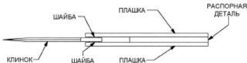
Схема 2. Для того чтобы рассчитать толщину распорной детали, измерьте толщину клинка, прибавьте к этому значению толщину шайб и задайте допуск от 0,03 до 0,13 мм, чтобы уменьшить трение
